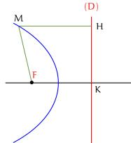
On se donne un point F, une droite (D) ne passant pas par F et un réel strictement positif e. La conique de **foyer** F, de **directrice** (D) et d'**excentricité** e est l'ensemble ( $\Gamma$ ) des points du plan tel que  $\frac{\mathsf{MF}}{\mathsf{d}(\mathsf{M},(\mathsf{D}))} = e$ . Ainsi, en notant H le projeté orthogonal du point M sur la directrice (D),
